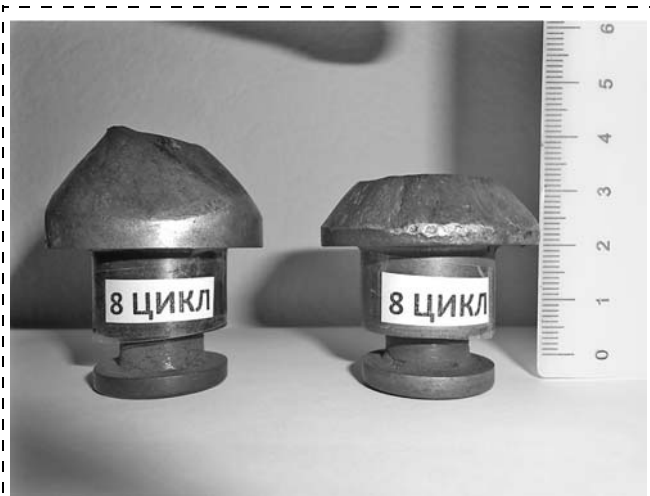
Рис. 6. Состояние сменных головок после восьмого цикла испытаний резцов
