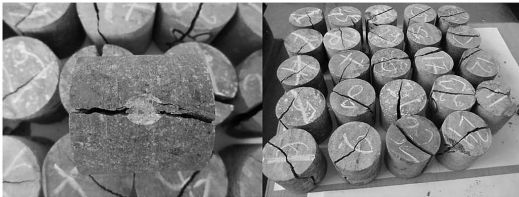
Рис. 5. Разрушение образцов под воздействием стального шара
