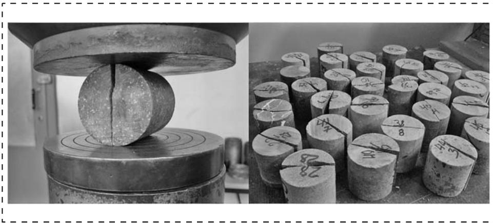
Рис. 2. Раскалывание образцов
