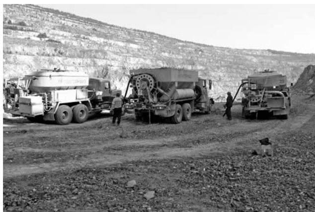
Приготовление порэмита 1А СЗМ МЗВ-8, МЗВ-10 и СЗМ-8 и зарядка им скважин на локальном блоке
