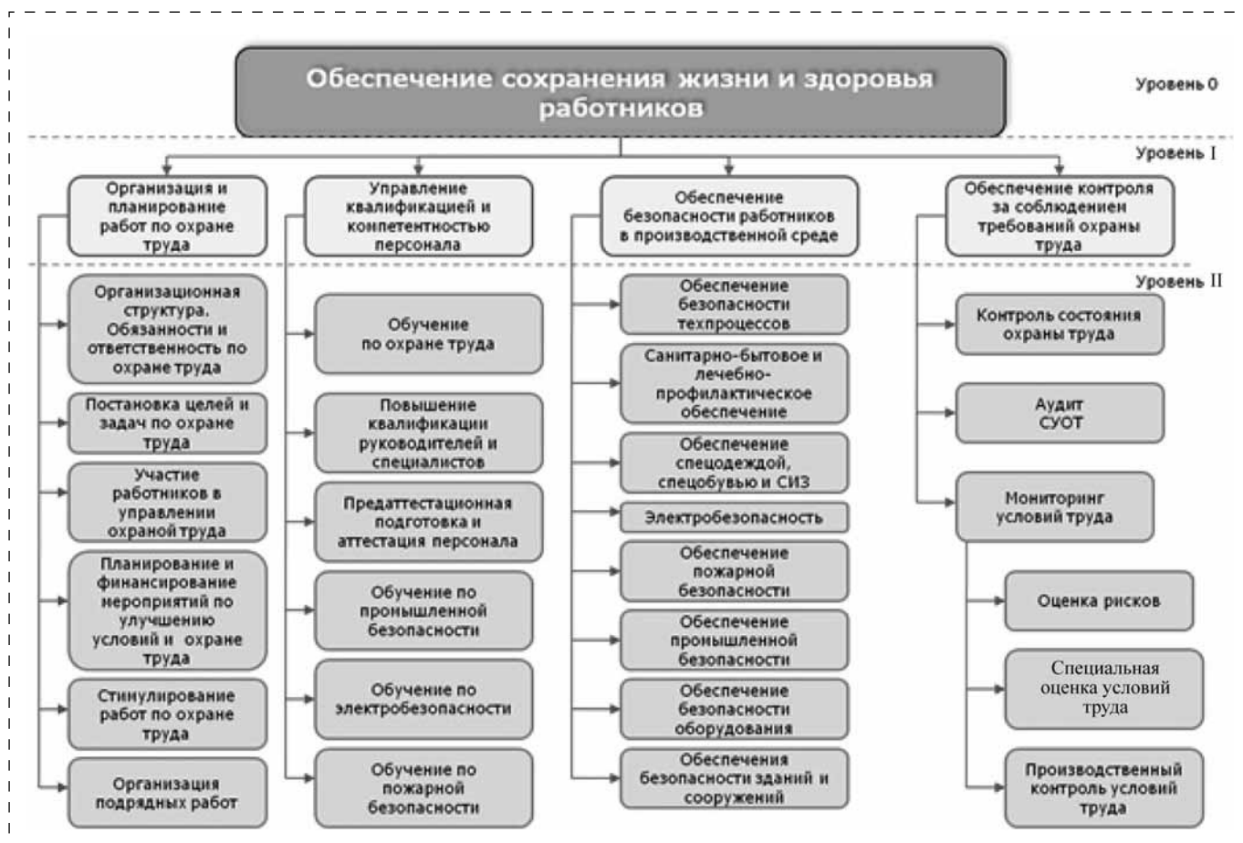
Рис. 2. Декомпозиция процессов системы управления охраной труда (СУОТ)
