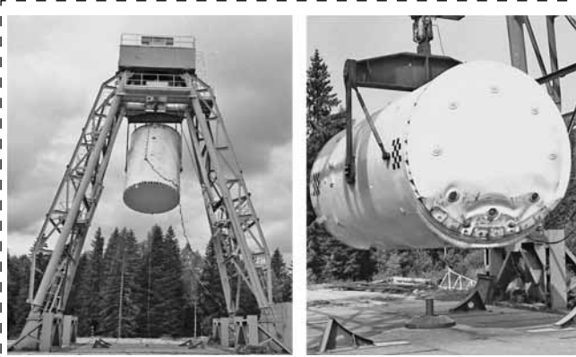
Рис. 8. Испытания ТУК-104 на аварийные условия перевозки (бросок с 9 м и с 1 м на штырь)
