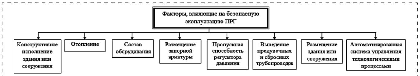
Рис. 2. Структура факторов, влияющих на безопасную эксплуатацию ПРГ
