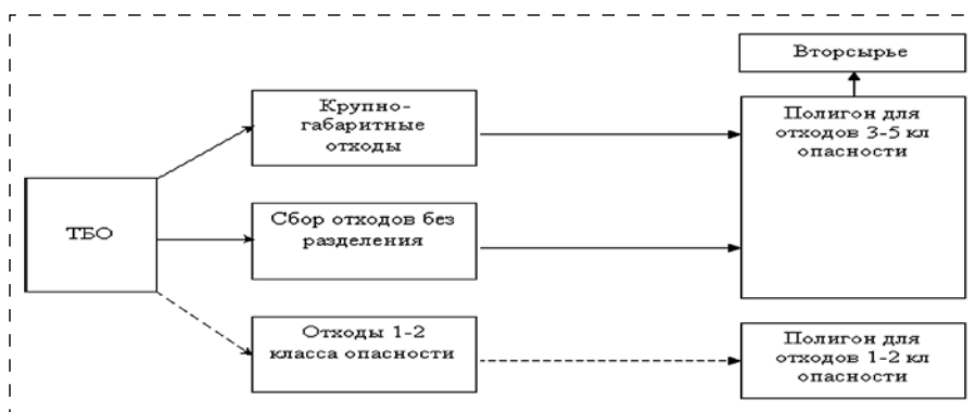
Рис.2. Схема использования отходов при их полигонном захоронении
