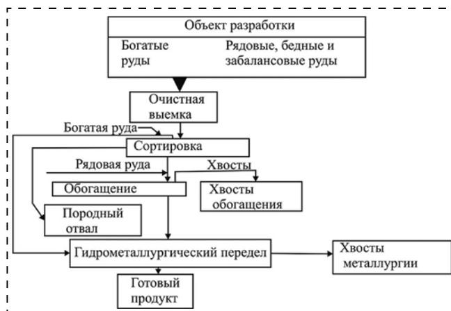
Рис. 1. Традиционная схема добычи и переработки руд
