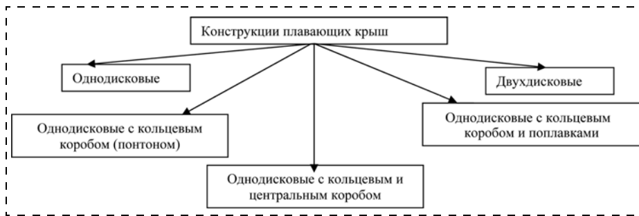
Рис. 2. Классификация плавающих крыш по типу применяемой конструкции
