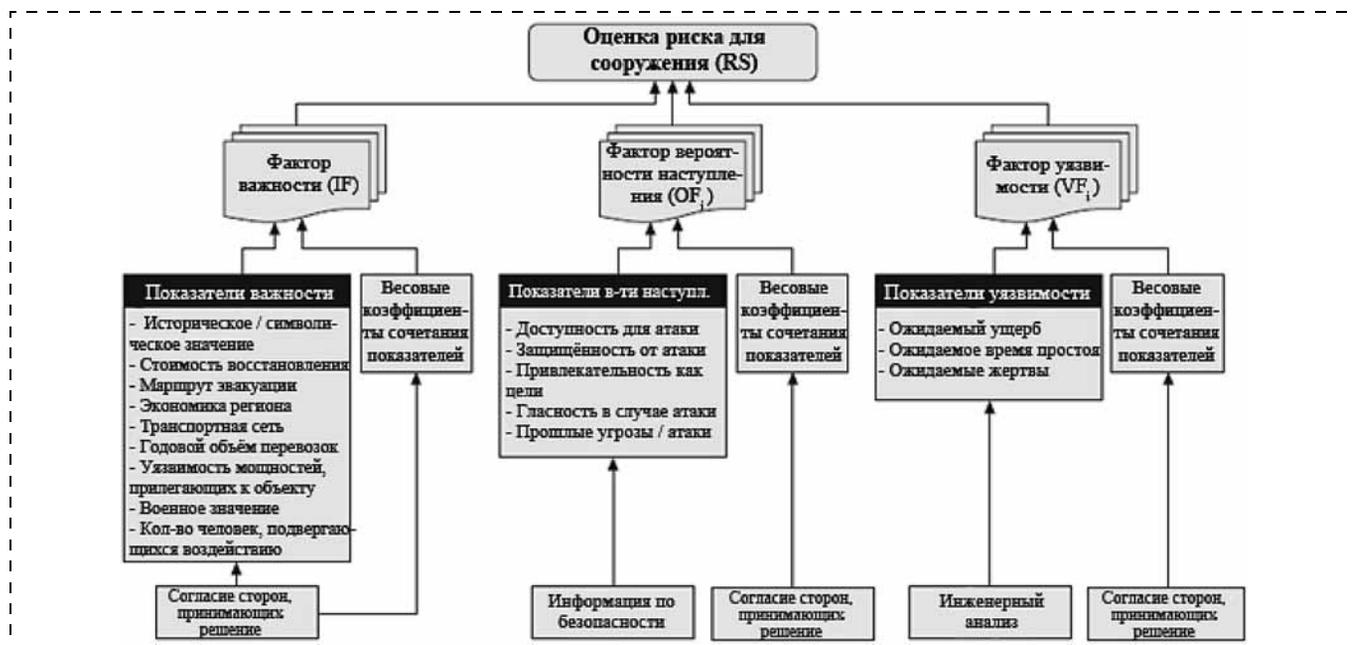
Рис. 1. Компоненты оценки риска для автомобильного моста
