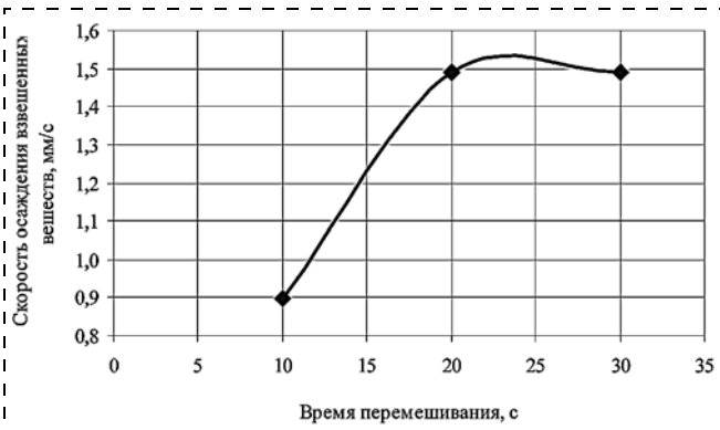
Рис. 4. Зависимость скорости осаждения взвешенных веществ от времени перемешивания при использовании флокулянта Eлvigo 4255y
