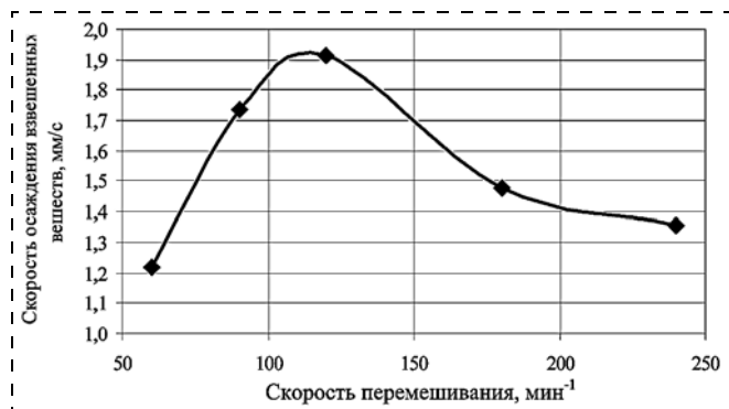
Рис. 3. Зависимость скорости осаждения взвешенных веществ от скорости перемешивания при использовании флокулянта Eлvigo 4255y
