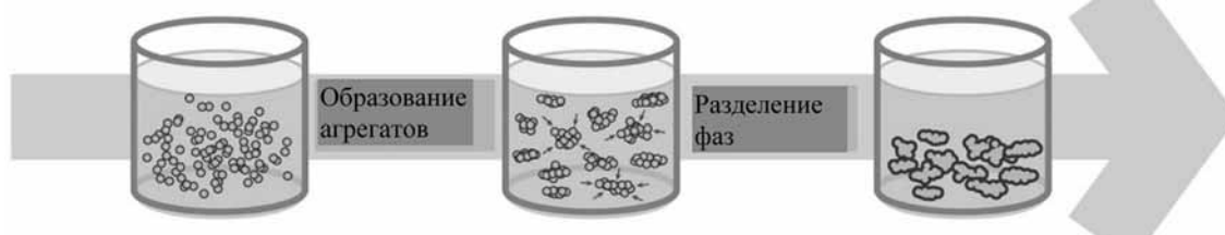
Рис. 1. Схема адсорбции макромолекул флокулянта на частицах дисперсной фазы
