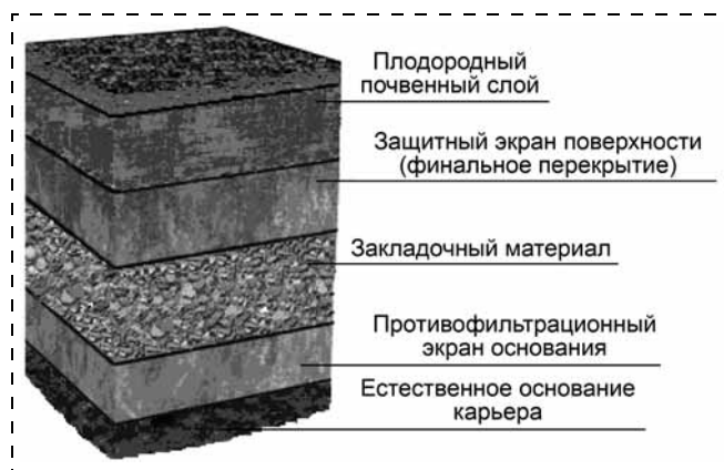
Схема использования закладочного материала с пылью электрофильтров и цитрогипса при рекультивации карьеров
