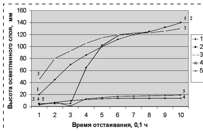
Рис. 3. Осветление сброженных осадков, промытых водопроводной водой, при введении смеси FeCl_3 и CaO в соотношении:
