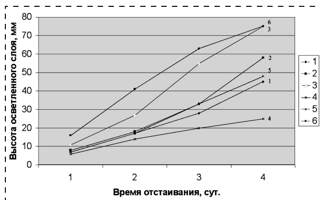
Рис. 2. Осветление сброженных осадков при введении смеси \text{FeCl}_3 и \text{CaO} в соотношении \text{FeCl}_3/\text{CaO} :
