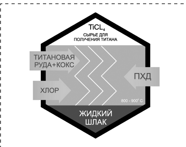
Рис. 3. Схема нейтрализации диоксиноподобных веществ
