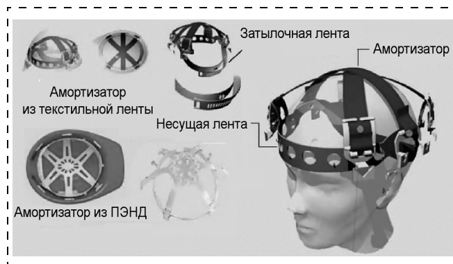
Рис. 2. Конструкция внутренней оснастки (ПЭНД — полиэтилен низкого давления)
