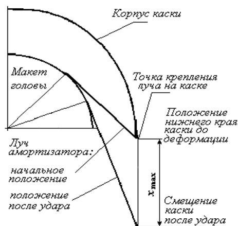
Рис. 9. Модель деформации луча амортизатора
