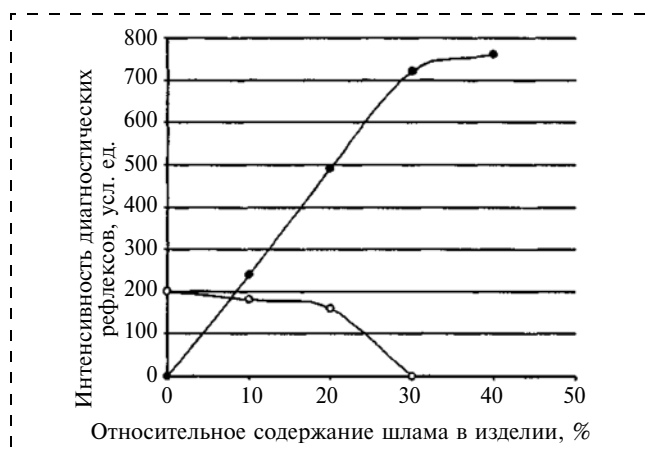
Рис. 2. Изменение интенсивности диагностических рефлексов d = 2,84 А геленита (линия с черными точками) и d = 2,69 А гематита (линия с белыми точками) в зависимости от относительного содержания шлама в изделии ( d — межплоскостное расстояние)
