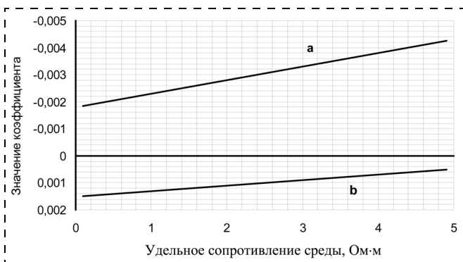
Рис. 13. Определение коэффициентов a и b в уравнении для определения значения поляризационного потенциала под покрытием
