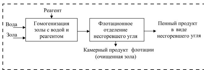
Рис. 3. Схема процесса флотационной обработки золы
