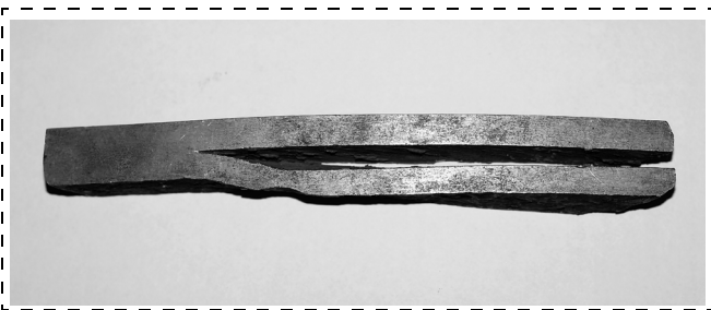
Рис. 1. Макроструктура расслоения металла обечайки пропановой емкости из стали 20К ( P_{\text{раб}} = 0,2 МПа, T_{\text{раб}} = 60 °С)
