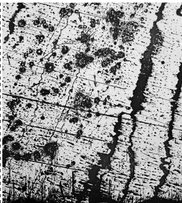
Рис. 4. Микроструктура разрушенного образца трубы со стороны наружной поверхности (видны игольчатые выделения нитридной фазы)
