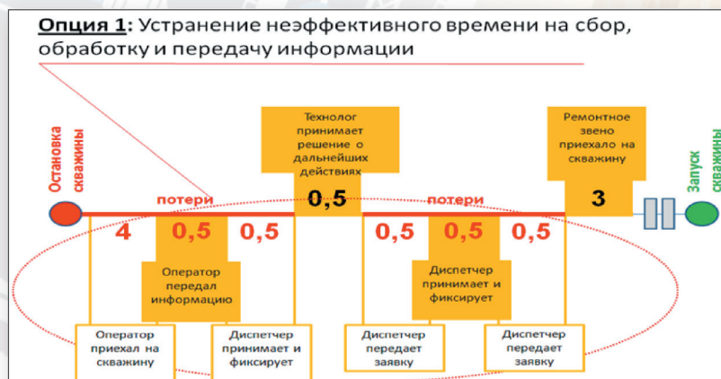
Рис. 3. Оптимизация процесса обслуживания скважин
