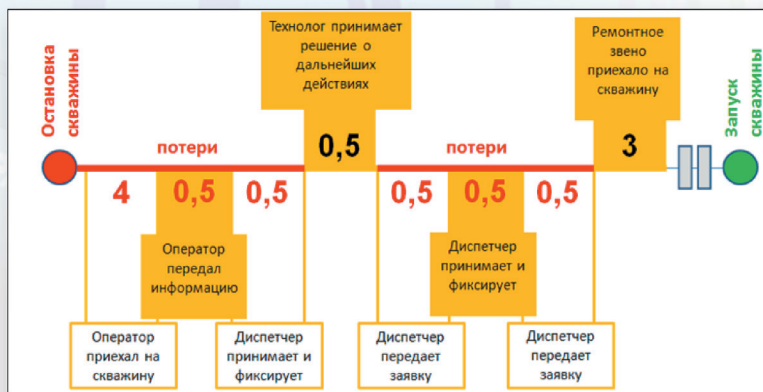
Рис. 2. Процесс обслуживания скважин
