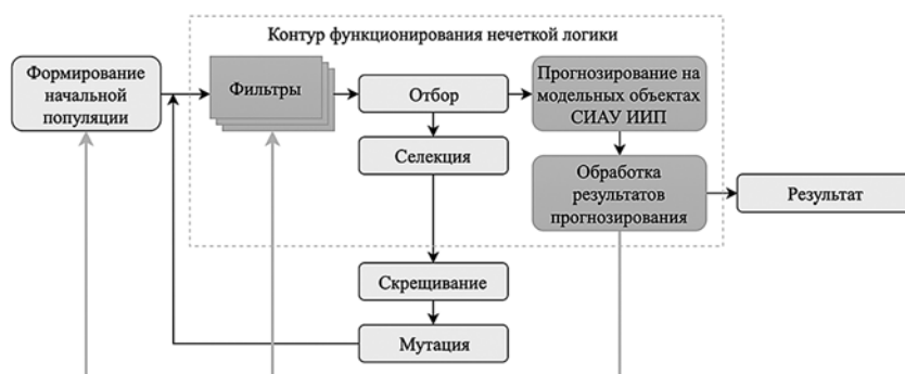
Рис. 3. Блок-схема модернизированного генетического алгоритма поиска рационального решения задачи управления трафиком вычислительной сети
