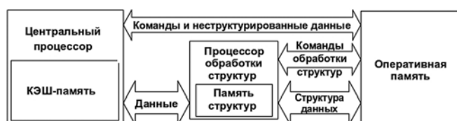
Рис. 2. Поток команд и данных в системе с аппаратной обработкой множеств и структур данных
