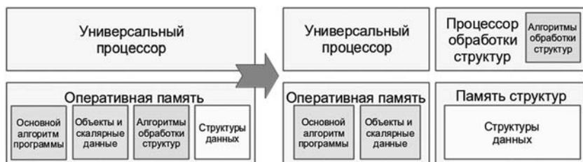
Рис. 1. Вычислительная система с аппаратной поддержкой операций над множествами и структурами данных
