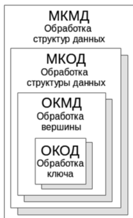
Рис. 5. Принцип иерархической вложенности классов вычислительных систем при обработке структур данных и множеств
