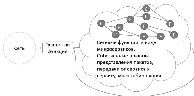
Рис. 4. Предлагаемое размещение сетевых функций: F — различные сетевые функции; C — клоны сетевых функций, выполняющие ту же функциональность
