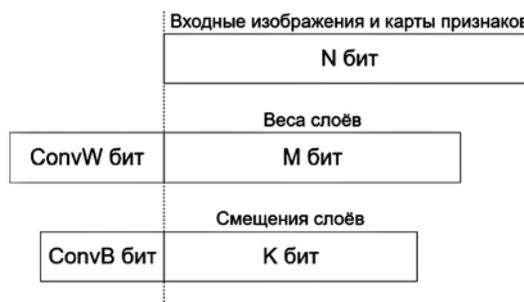
Рис. 5. Разная размерность весов, смещений и карт признаков
