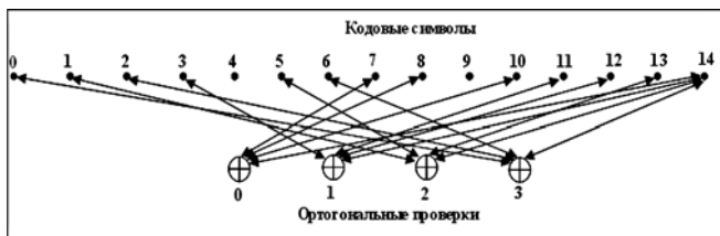
Рис. 1. Вид графа Таннера для низкоплотного кода EG(2, 2^2) с параметрами J_N = J_D = 4 ( \oplus — сложение в поле GF(2) )
