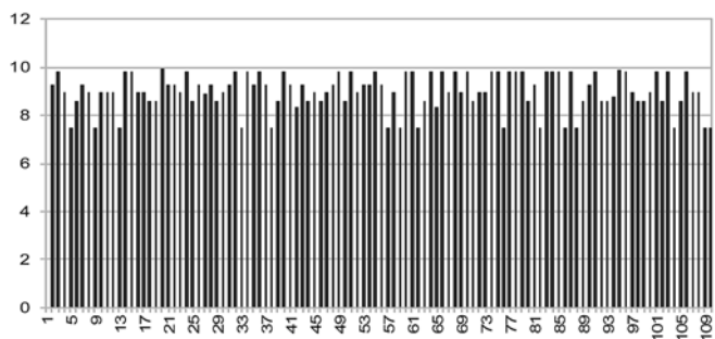
Рис. 5. Разделение пропускной способности внешнего канала между пользователями CPE. По оси X — номер клиента, по оси Y — средняя загрузка в Мбит/с
