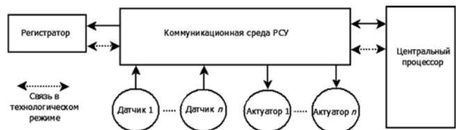
Рис. 6. Схема подключения регистратора к системе управления
