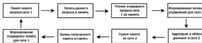
Рис. 2. Обобщенный алгоритм функционирования конвертора
