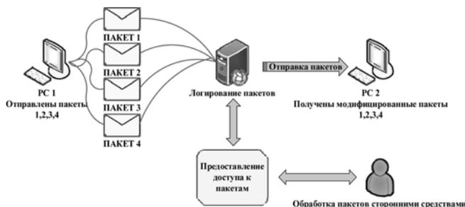
Рис. 2. Модель модификации сетевых пакетов с использованием сторонних средств
