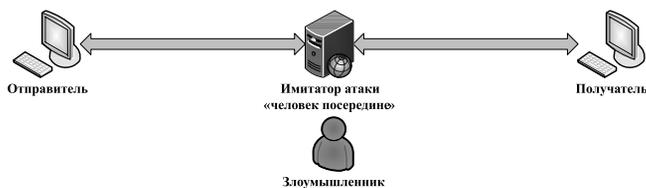
Рис. 1. Общая схема модели, имитирующей поведение злоумышленника в сети
