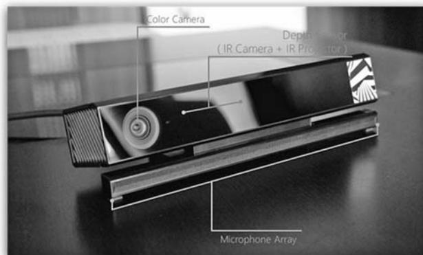
Рис. 1. Сенсоры и датчики Kinect второго поколения
