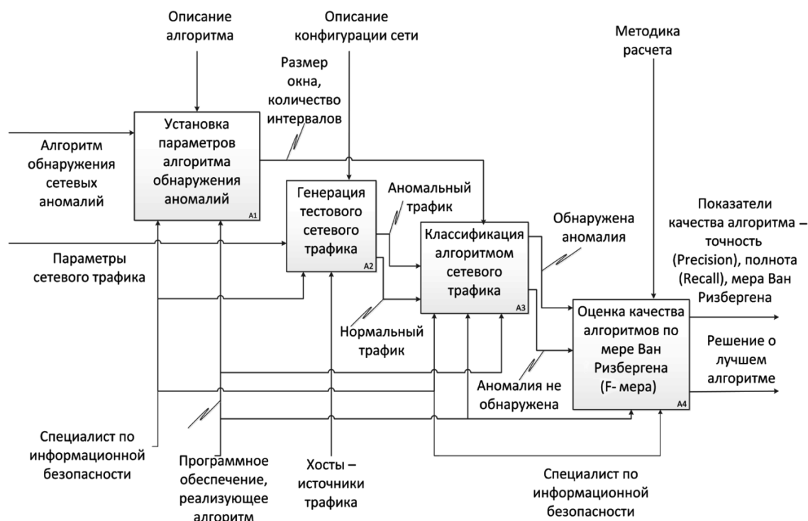
Рис. 1. Модель исследования качества алгоритмов обнаружения сетевых аномалий
