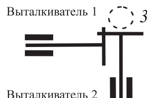
Рис. 3. Аварийная ситуация (оба поршня выдвинуты)
