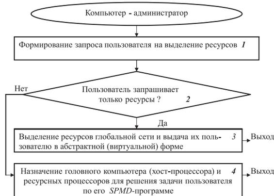
Рис. 1. Алгоритм управления компьютера — администратора Центра
