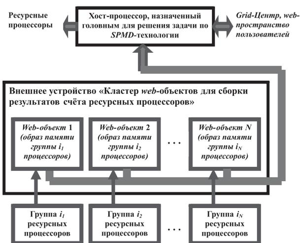
Рис. 5. Структура связей кластера web-объектов для сборки данных
