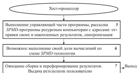
Рис. 2. Алгоритм управления, реализуемый хост-процессором
