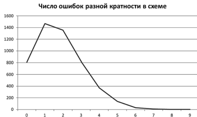
Рис. 2. График числа ошибок в зависимости от кратности для одного из тестов на 5000 запусков метода Монте-Карло
