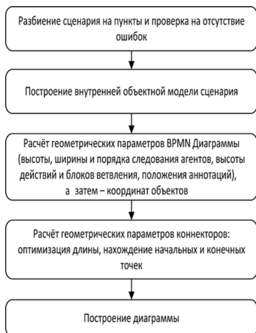
Рис. 2. Схема работы генератора диаграмм
