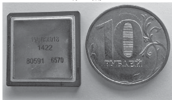
Рис. 6. Структурная схема и фотография микросхемы коммутатора RapidIO 1907KX018
