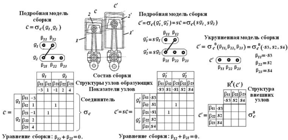
Рис. 4. Размерно-подобный ряд изделий и их структурные модели с матрицами смежности узлов сопряжения образующих
