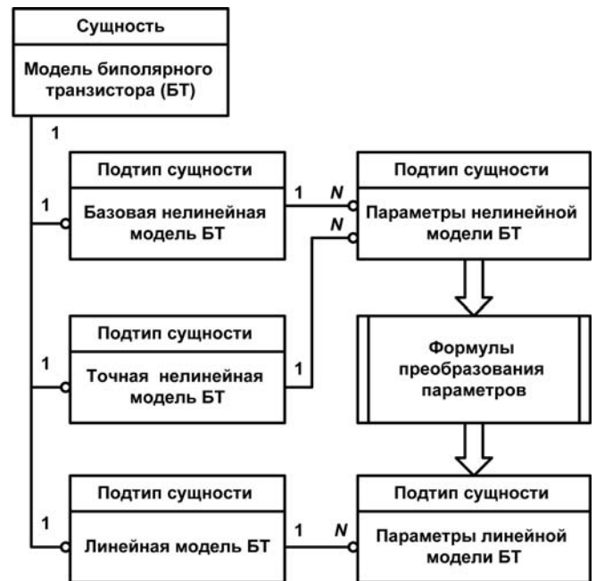
Рис. 2. Обобщенная ER-диаграмма моделей биполярного транзистора
