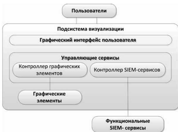
Рис. 3. Архитектура подсистемы визуализации
