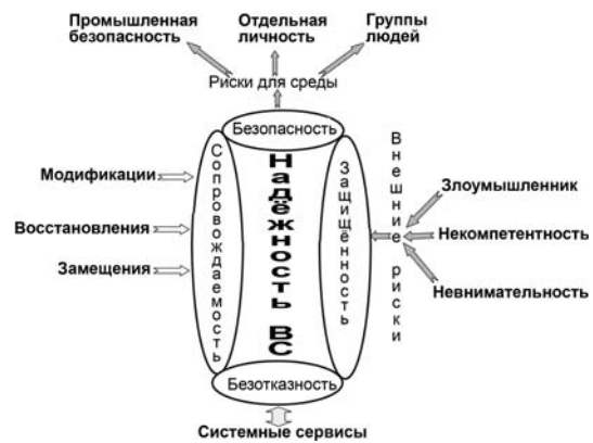
Рис. 2. Базовые показатели надежности ВС и внешние воздействия
