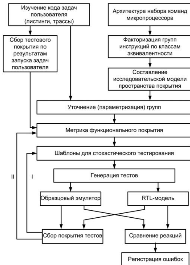
Рис. 5. Получение метрики функционального покрытия для "встречного тестирования" модели микропроцессора
