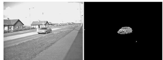
**Рис. 2. Выделение движущегося объекта с помощью импульсной нейронной сети**
