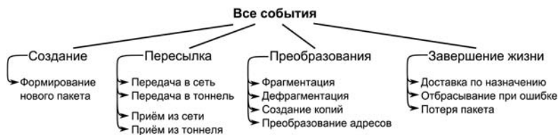
Рис. 1. Классификация событий жизненного цикла IP-пакетов
