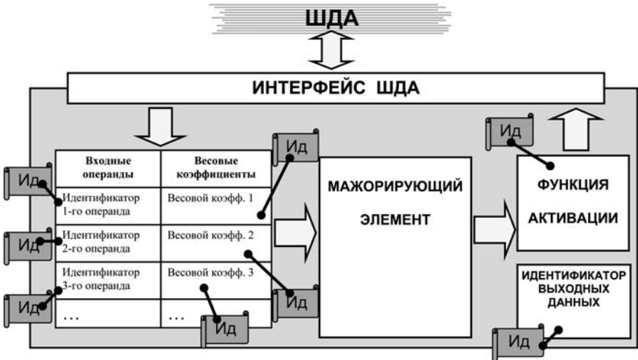
Рис. 2. Структура ФУ-нейрона для нейронной сети без обратных связей
