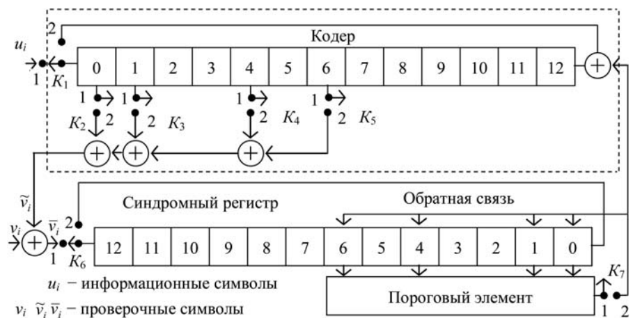
Рис. 4. Структурная схема ПДК для СОК длиной (26, 13)
