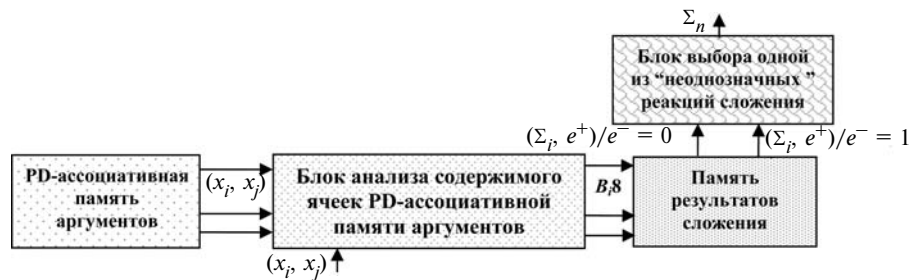
Рис. 1. Структурно-функциональная схема бит-поточкового ассоциативного символьного сумматора
