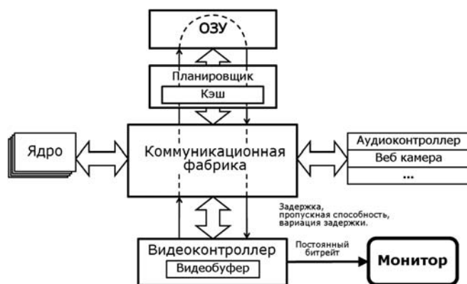
Рис. 1. Функционирование видеоконтроллера в составе системы на кристалле
