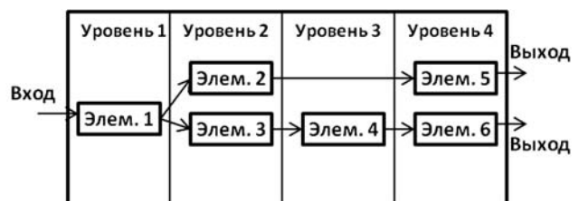
Рис. 5. Пример параллелизации с ранжированием
