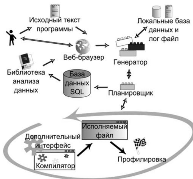
Рис. 1. Архитектура автоматизированного инструмента
