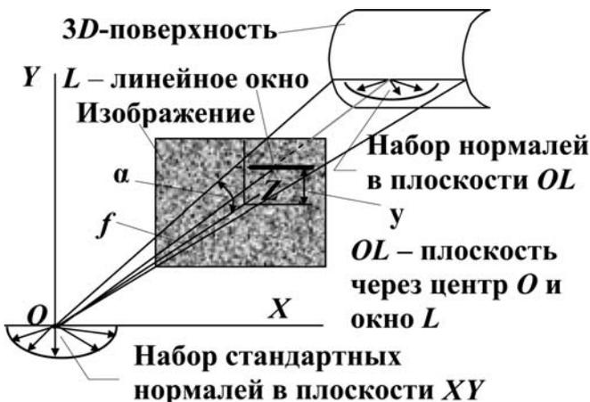
Рис. 5. Вычисление набора нормалей для горизонтального линейного окна
