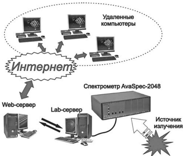
Рис. 1. Схема проведения эксперимента по спектроскопии плазмы через глобальную сеть
