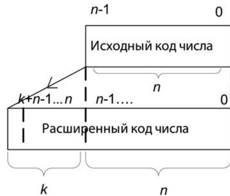
Рис. 10. Исходная и расширенная разрядные сетки (исходный и расширенный коды)
