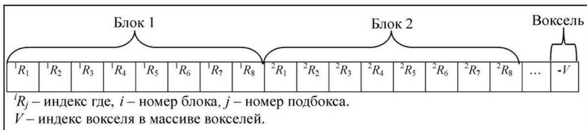
Рис. 3. Структура октодерева. Каждый блок содержит 8 индексов по 4 байта
