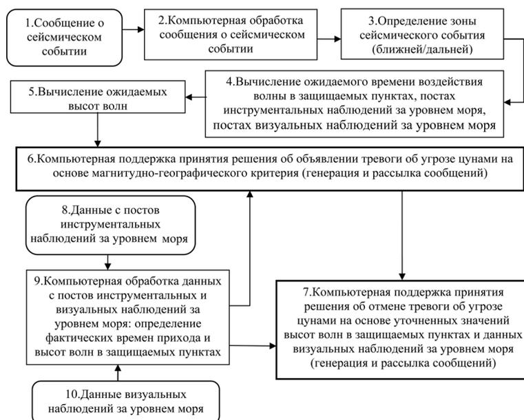
Рис. 1. Схема компьютерной поддержки принятия решений об угрозе цунами
