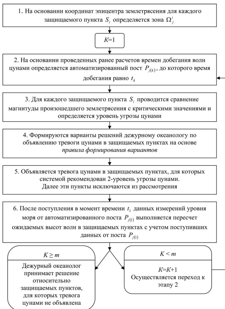
Рис. 4. Последовательность действий, выполняемая в процессе принятия решения об угрозе цунами с использованием АИСПЦ
