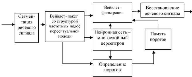
Рис. 1. Блок-схема метода вейвлет-фильтрации речевого сигнала с применением перцептуальной модели и нейросетевого алгоритма
