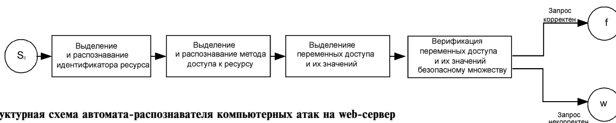
Рис. 1. Функциональная модель системы обнаружения компьютерных атак на web-сервер
