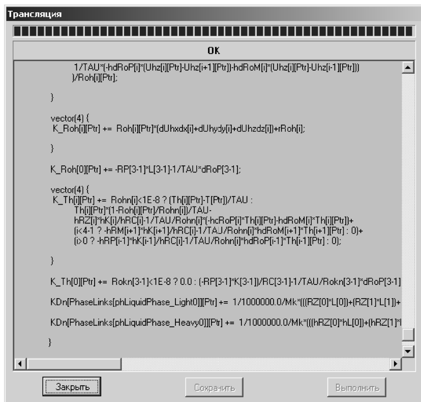
Рис. 4. Пример результата трансляции модели на язык C
