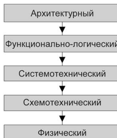
Рис. 2. Иерархическая схема САПР обобщенного объекта проектирования
